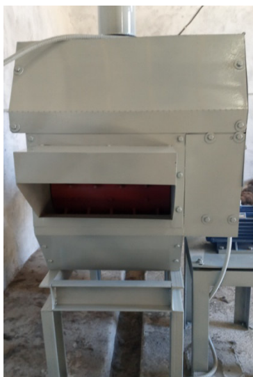
11-рис. Экспериментальный образец разрыхлительной машины для шерсти
