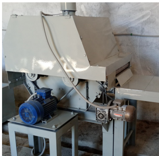
11-рис. Экспериментальный образец разрыхлительной машины для шерсти
